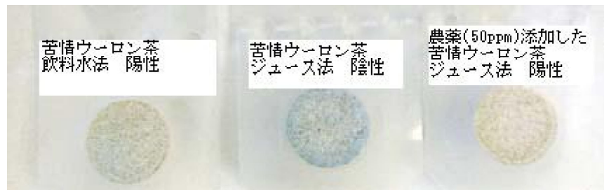
写真1 苦情ウーロン茶についての農薬簡易キットによる検査結果
